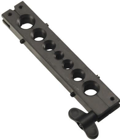
Die Bohrungen dieses Einsatzes sind auf einer Seite zu 90° abgefast, um konische Bünde mit dem Fräser zu bilden, und auf der anderen Seite im gebrochenen Winkel bearbeitet, um mit Hilfe der Dorne nach Vorformung mit einem konischen Fräser flache Bünde zu erhalten.
