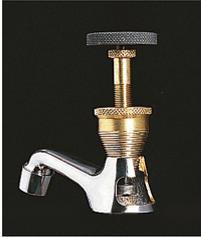
Ventilsitz-Fräsapparat Feder zum Halten der Fräse während des Kontakts mit dem Ventilsitz. Fräse am Ende geschliffen, auf Fräsenhalter geschraubt.
