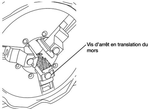
Remplacez le téton, le ressort et la vis et serrez la vis de fixation du mors.
