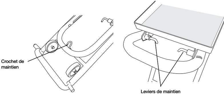
Posez la machine sur son support, arrière de la machine vers la poignée, et fixez les vis de maintien fournies avec le chariot.
