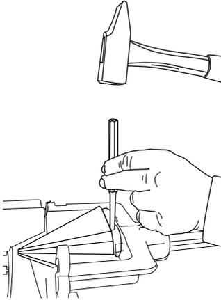
Retirez le cône, remplacez-le par le nouveau et replacez la goupille.
