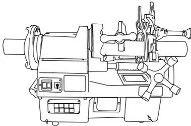
Placez le coupe-tubes sur le tube et serrez-le pour qu'il soit bien maintenu.
