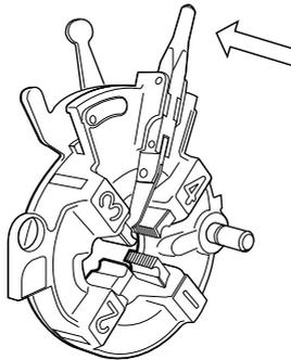
Desserrez le levier de blocage du plateau porte-cames en le tournant dans le sens inverse de celui indiqué par la flèche :
