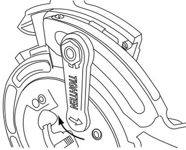
*Remarque : Sur le levier est inscrite l'indication "Tighten" accompagnée d'une flèche orientée dans le sens antihoraire. Cette flèche indique le sens de serrage (en anglais, "tighten" signifie "serrer").*
