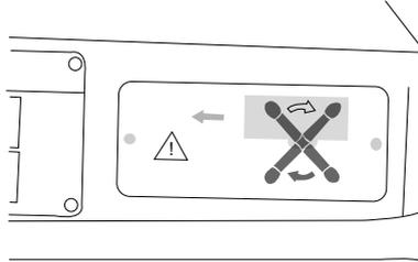
Tournez lentement le volant vers la droite en forçant pour permettre aux peignes d'entamer l'extrémité du tube.
