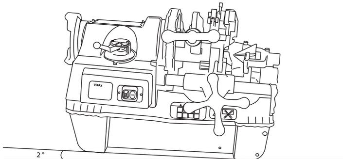
Cette inclinaison permet d'éviter que l'huile ne coule vers l'arrière dans le tube. Veillez donc à ce que cette inclinaison soit respectée sur l'emplacement de travail.
