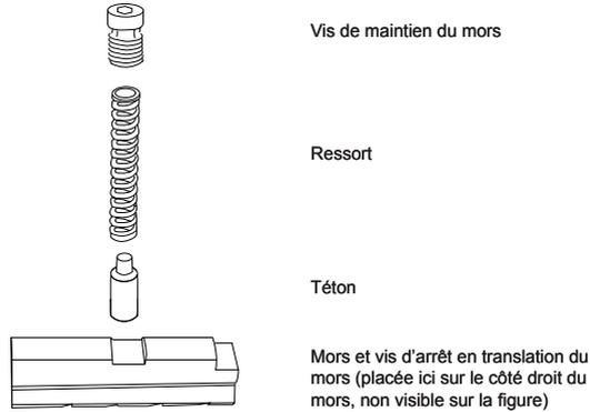
**Important :** Veillez à ne pas perdre la vis d'arrêt en translation du mors insérée sur le côté du mors.
