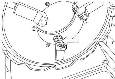
Les mors du mandrin avant doivent être remplacés lorsqu'ils montrent des signes d'usure.
