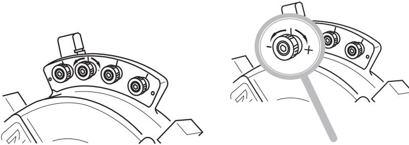
*Remarque : Les molettes de réglage possèdent des repères qui permettent de régler finement le diamètre extérieur de filetage :*
