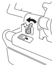
*Remarque :* Les positions intermédiaires permettent de régler le débit d'huile nécessaire à la bonne lubrification du filetage.
