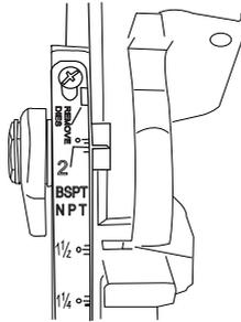
*Remarque : La tête est livrée avec une réglette correspondant aux filetages BSPT et NPT. Les réglages BSPT sont matérialisés par des traits rouges simples ; les réglages NPT sont matérialisés par des traits rouges accompagnés d'un point bleu.*
