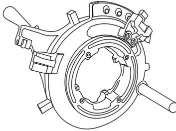
La tête de filetage 4" permet de fileter des tubes de 2 1/2 à 4". Les deux standards de filetage utilisables avec cette tête sont les filetages BSPT et NPT. (Une tête 4" est dédiée à l'un ou l'autre de ces deux standards.)
