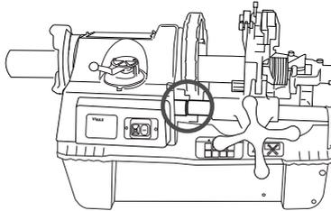
**Le chariot ne doit en effet jamais dépasser cette limite :** un dépassement de cette limite produit un arrachage du filetage et peut même provoquer la déchirure du tube.
