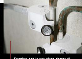
Pratico con le sue pinze dotate di termometri regolabili dalle punte flessibili
