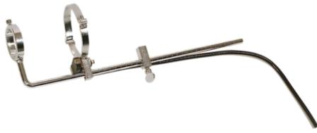
To urządzenie umożliwia powtarzanie takich samych operacji gięcia na giętarkach hydraulicznych z silnikiem elektrycznym wyposażonym w silownik nr 2 (240802).
