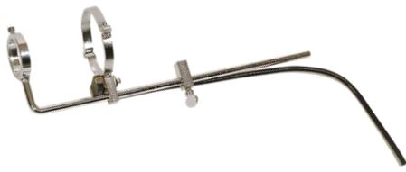
Toto zařízení umožňuje napodobit stejný ohyb na hydraulické ohýbačce s elektrickým motorem vybavené zvedákem č. 2 (240802).
