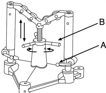
Lösen Sie durch Drehen im entgegengesetzten Uhrzeigersinn die Hebel der Zentrierschraube (A). Stellen Sie das Rohr durch Drehen des Rades der Zentrierschraube (B) auf das Rändelmaß ein.
