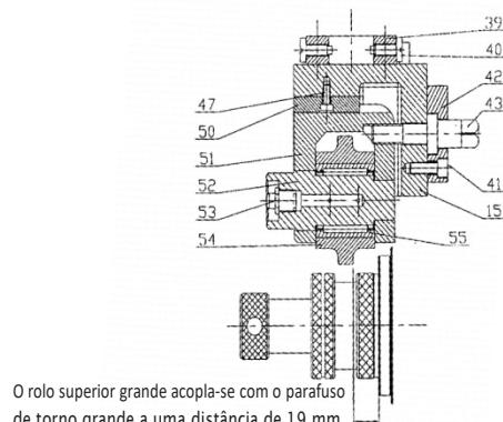
O rolo superior grande acopla-se com o parafuso de torno grande a uma distância de 19 mm.
