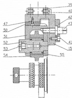
Широкие верхние роликовые пары к широкой части ведущего вала на расстоянии 19 мм. Узкие пары нижних концов роликов к узкой части ведущего вала на расстоянии 15,88 мм.
