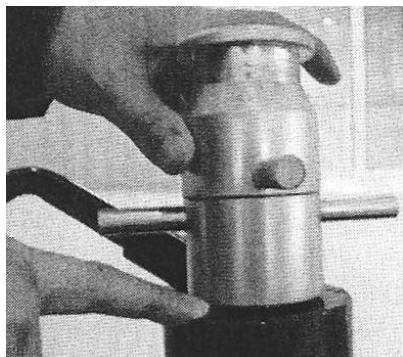
Paso 8: Arrancar la máquina, atrasar al máximo el rodillo superior, cerrar la válvula de cierre del cilindro y comenzar a bombeo. No bombeo de forma continua, dejar que el tubo dé tres vueltas por cada bombeo. Cuando la tuerca de ajuste toque el cilindro hidráulico dejar de bombeo y no parar la máquina hasta que el tubo haya dado tres vueltas. Parar la máquina, abrir la válvula de cierre del cilindro, para que retroceda el cilindro hidráulico, y retirar el tubo.
