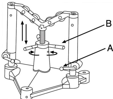
Allentare le leve della vite del tornio (A) ruotandole in senso antiorario.
