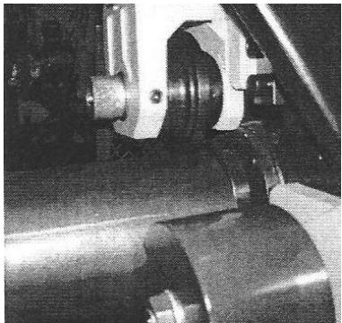
Paso 2: Girar la tuerca de ajuste hasta que haya contacto con el cilindro hidráulico.
