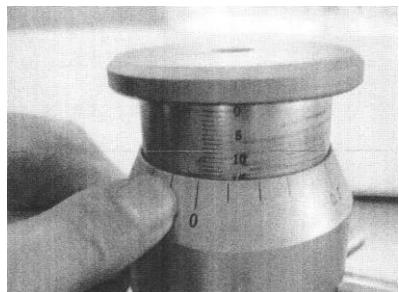
Βήμα 5: Διορθώστε το βάθος αυλακιού. Για παράδειγμα για 4" το βάθος είναι 2.11mm. Τραβήξτε προς τα πίσω το παξιμάδι εμπλοκής κατά 2.11mm στην κατακόρυφη κλίμακα. Κάθε γραμμή της κυκλικής κλίμακας ισοδυναμεί με 0.1mm.
