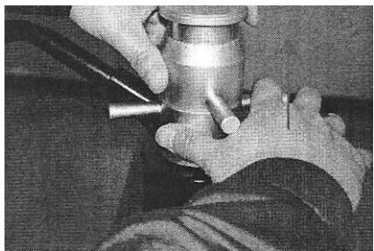
Etap 7: Po zablokowaniu zwracać uwagę, aby odległość pomiędzy przeciwnakrętką a siłownikiem hydraulicznym wynosiła 2,11 mm.
