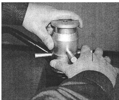
Étape 7 : Une fois verrouillé, veillez à ce que la distance entre le contre-écrou et le vérin hydraulique soit de 2,11 mm.
