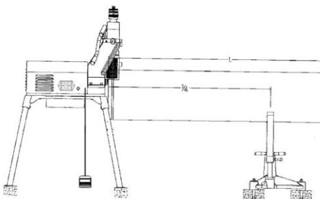
As extremidades do tubo têm de ser cortadas em ângulo recto. Não utilize um maçarico para cortar o tubo. O tubo não deve ser insuficientemente redondo. É necessário amolar todas as costuras de soldaduras, vedações e outras costuras interiores ou exteriores existentes no tubo numa extensão de, pelo menos, 55 mm a partir da extremidade.
