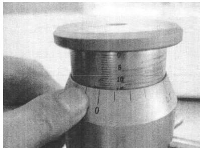
Schritt 5: Fixieren Sie die Rillentiefe. Als Beispiel: bei 4Zoll beträgt die Tiefe 2,11mm. Ziehen Sie die Gegenmutter 2,11mm auf der senkrechten Skala zurück. Jeder Strich auf der kreisförmigen Skala entspricht 0,1mm.
