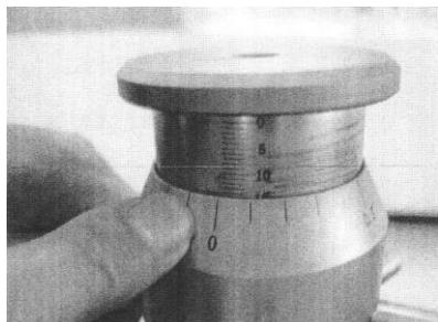
Paso 5: Fijar la profundidad de la ranura. Por ejemplo para 4" la profundidad es 2,11mm. Retroceder la tuerca de bloqueo 2,11mm en la escala vertical. Cada linea de la escala circular es equivalente a 0,1mm.
