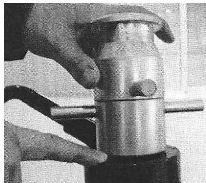
Stap 8: Start the machine, trek de bovenrol zover mogelijk terug, sluit de afsluitklep van de cilinder en begin te pompen. Pomp niet voortdurend, laat de pomp toe drie keren te roteren voor elk pompbewerking. Als de stelmoer de hydraulische cilinder aanraakt, stop dan met pompen en stop de machine niet vooraleer de buis drie keren geroteerd heeft. Stop de machine, open de afsluitklep van de cilinder om ervoor te zorgen dat de hydraulische cilinder achteruitgaat en verwijder de buis.
