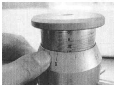
Шаг 5: Шаг 5. Зафиксируйте глубину канавки. Например, для 4" глубина составляет 2,11 мм. Потяните назад зажимную гайку 2,11 мм по вертикальной шкале. Каждое деление круговой шкалы эквивалентно 0,1 мм.
