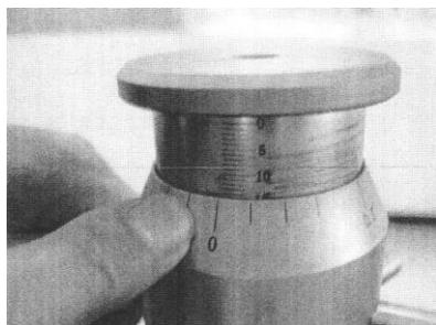
Étape 5 : Fixez la profondeur de rainurage. Par exemple pour 4" la profondeur est de 2,11 mm. Remontez l'écrou de réglage de 2,11 mm sur l'échelle verticale. Chaque ligne de l'échelle circulaire est équivalente à 0,1 mm.
