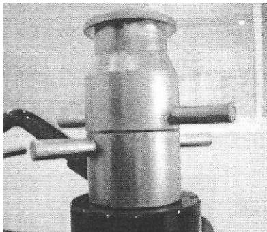
Paso 4: Tomar nota de la posición de la calibración vertical (15) y horizontal (0).
