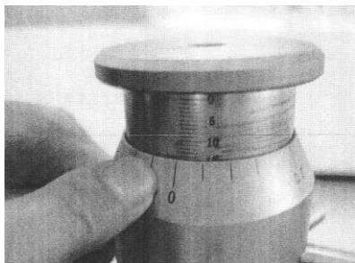
Stap 3: Draai de zijmoer tot ze in aanraking komt met de stelmoer.
