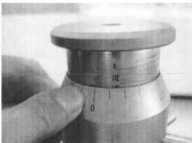
Passo 5: Fixe a profundidade da ranhura. Por exemplo, para 4“ a profundidade é 2,11 mm. Retroceda a porca de bloqueio 2,11 mm na escala vertical. Cada linha da escala circular é equivalente a 0,1 mm.
