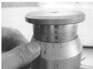
Etap 5: Ustalić głębokość żlobkowania. Przykładowo dla rury 4" głębokość wynosi 2,11 mm. Podnieść nakrętkę regulacyjną na skali pionowej o 2,11 mm. Każda linia skali obwodowej odpowiada 0,1 mm.
