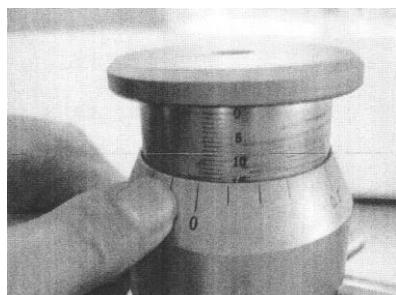
Passo 5: Fissare la profondità della scanalatura. Ad esempio per 4" la profondità è di 2,11 mm. Tirare indietro il dado per montante di 2,11 mm sulla scala verticale. Ogni linea della scala circolare equivale a 0,1 mm.
