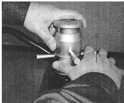
Passo 7: Depois de fixar, certifique-se de que a distância entre a porca de ajuste e o cilindro hidráulico é de 2,11 mm.
