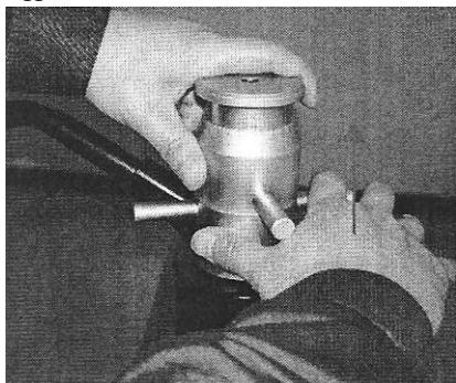
Passo 7: Una volta bloccato, assicurarsi che la distanza tra il dado di regolazione e il cilindro idraulico sia di 2,11 mm.
