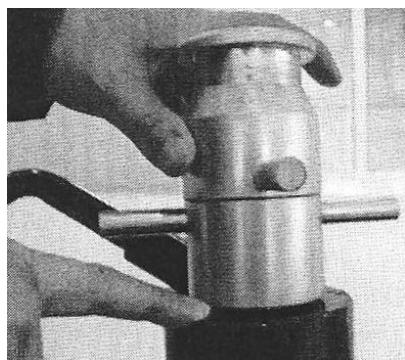
Aşama 8: Makineyi çalıştırın, üst ruloyu olabildiğince uzaga itin, silindirin durdurma vanasını kapatın ve pompalamaya başlayın. Sürekli olarak pompalamayın, her pompalama işleminde tüpün üç defa dönmesini bekleyin. Kontra somunu hidrolik silindire deðdiðinde, pompalamayı durdurun, ancak tüp üç defa dönmeden önce makineyi durdurmayın. Makineyi durdurun, hidrolik silindirin içeri çekildiðinden emin olmak için silindirin durdurma vanasını açın ve tüpü çıkarın.
