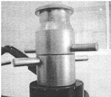
Étape 2 : Faites tourner le contre-écrou jusqu'à ce qu'il soit en contact avec le vérin hydraulique.
