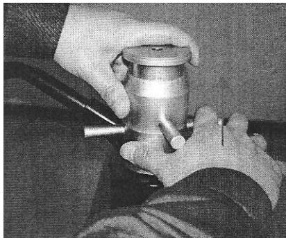
Schritt 7: Gehen Sie nach dem Festziehen sicher, dass der Abstand zwischen Stellmutter und Hydrozylinder 2,11 mm beträgt.
