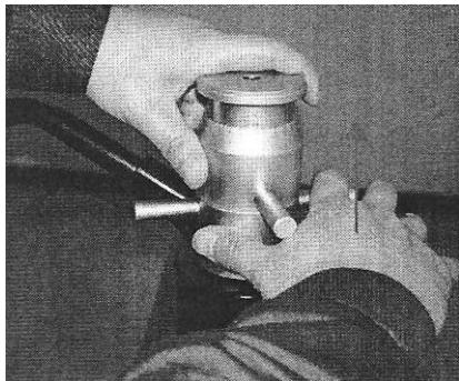
Paso 7: Una vez bloqueadas comprobaremos que la distancia entre la tuerca de ajuste y el cilindro hidráulico es de 2,11 mm.
