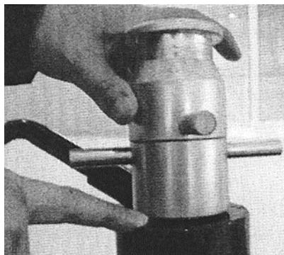
Шаг 8: Запустите машину, отодвиньте верхний ролик как можно дальше, закройте запорный клапан цилиндра и начинайте качать. Не качайте непрерывно, дайте трубе провернуться три раза за каждую операцию по прокачке. Когда установочная гайка коснется гидравлического цилиндра, остановите насос и не останавливайте машину до тех пор, пока труба не провернется три раза. Остановите машину, откройте запорный клапан цилиндра, чтобы убедиться, что гидравлический цилиндр отошел, и снимите трубу.
