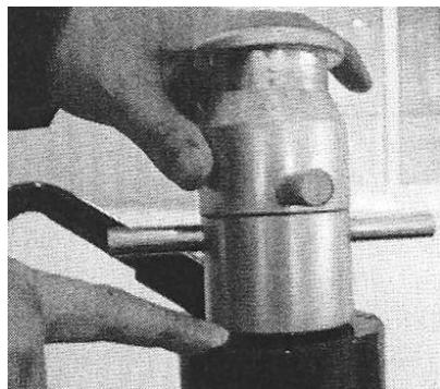
Passo 8: Ligue a máquina, afaste o rolo superior o máximo possível, feche a válvula de fecho do cilindro e comece a bombeiar. Não bombeie continuamente; deixe que o tubo rode três vezes por cada bombeamento. Quando a porca de ajuste tocar no cilindro hidráulico pare de bombeiar, mas não desligue a máquina até que o tubo tenha dado três voltas. Pare a máquina, abra a válvula de fecho do cilindro para que o cilindro hidráulico retroceda e retire o tubo.
