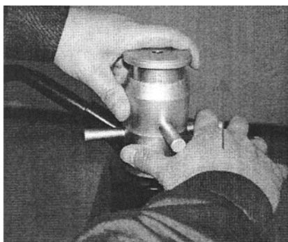
Шаг 7: После фиксации убедитесь, что расстояние между установочной гайкой и гидравлическим цилиндром составляет 2,11 мм.
