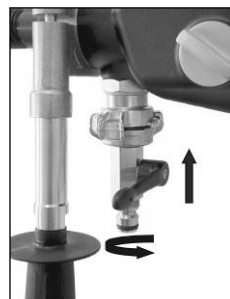
Zařízení pro připojení k vodnímu čerpadlu
