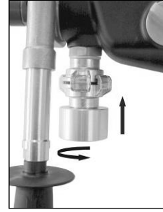
Tozlar için bir vakuma bağlanma sistemi
