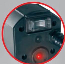
**Контроль процесса сверления:** индикатор тревоги с случае перегрузки.
