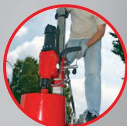
**Мощность и безопасность:** Двигатель с четырьмя типами защиты: термической, механической, электронной и системой постоянной смазки зубчатых колес.
