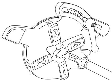
Η προαιρετική αυτή κεφαλή χρησιμοποιείται για τη διάνοιξη σπειρώματος σε σωλήνες με διαμέτρους 1/4" έως 3/8".
