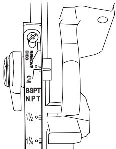
**Σημείωση:** Η κεφαλή παραδίδεται με κλίμακα για σπειρώματα BSPT και NPT. Οι ρυθμίσεις BSPT υποδεικνύονται με μεμονωμένες κόκκινες γραμμές. Οι ρυθμίσεις NPT υποδεικνύονται με κόκκινες γραμμές η κάθε μία εκ των οποίων συνοδεύεται από μία μπλε σπιγμή.
