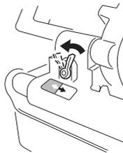
*Nota: As posições intermédias permitem o fluxo de óleo necessário para fornecer uma lubrificação correcta enquanto se realiza o corte da rosca a ser regulada.*
