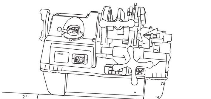
Esta inclinação impede o fluxo do óleo em direcção à parte traseira do tubo. Verifique portanto se esta inclinação é mantida sempre que for realizado qualquer trabalho.
