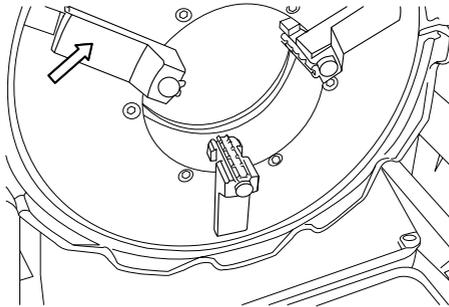
Os suportes dos grampos têm de ser substituídos quando apresentarem sinais de desgaste. (Suporte de grampo para a 162140: peça n.º 753070)
