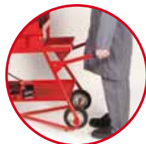
Desplazamiento sencillo de la máquina roscadora.
