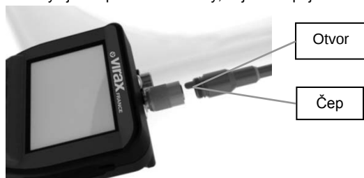
Obrázek 5 - Připojení kabelu (černý 9kolíkový konektor typu A)
