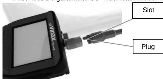
Abb 5 – Kabelanschlüsse (Anschlussstyp A, 9-poliger Stecker, schwarz).
