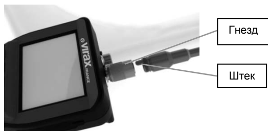
Рисунок 5 – Кабельное подключение (черный 9-штыревой коннектор типа А)
