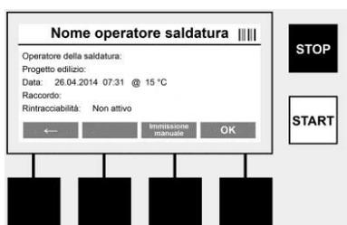
Alla voce di menu >SALDATURA< è possibile immettere i dati necessari per la saldatura. In tal senso è possibile effettuare la scansione di un codice a barre mediante uno scanner di codice a barre o a scelta anche manualmente mediante i tasti multifunzione.
