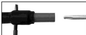
Per sostituire le prese di corrente, infilare una barretta o simili ( $\varnothing$  3mm) lateralmente nel foro sul connettore a vite e tenerla fermo. Svitare e rimuovere l'adattatore mediante un giraviti Torx 15.
