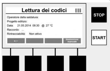
Eseguire la scansione del codice raccordo mediante lo scanner di codice a barre. Qualora lo scanner di codice a barre sia difettoso o non sia possibile leggere il codice raccordo, si può immettere il codice raccordo anche manualmente. Premere in tal senso il tasto >IMMISSIONE MANUALE< (vedi anche la sezione "Immissione").
