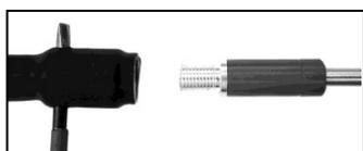
Appoggiare manualmente il nuovo adattatore e avvitare fino alla battuta e serrarlo a fondo mediante un giraviti Torx 15 (15 Nm), infine rimuovere la barretta.
