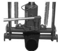
Si, malgré des réglages corrects, il n'est pas possible de faire descendre suffisamment le cylindre d'écrasement supérieur, il est possible que la tige filetée ne ressorte pas suffisamment du piston. Faites à nouveau remonter le cylindre d'écrasement supérieur, bloquez le piston et desserrez la tige filetée un peu plus à deux mains.
