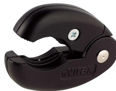
Taglia le guaine di protezione dei tubi in PE nonché la maggior parte delle guaine dei tubi elettrici fino a Ø 45 mm. Taglia la guaina all'estremità della scanalatura, lasciando intatto e privo di rigature il tubo situato all'interno della guaina. Corpo e guide delle lame ultra-resistenti. Lame in acciaio inossidabile molto resistenti, smontabili e intercambiabili. 2 modelli / 2 colori per adattarsi a tutte le guaine disponibili sul mercato.
