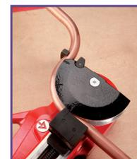
\* 251849 : Ø 28mm per tubi inox Ø 28 X 1,2 mm - Raggio di curvatura 112mm.
