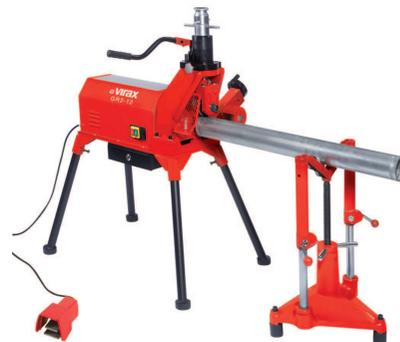
**Ηλεκτροϋδραυλικός μηχανισμός αυλακώσης**, για εν ψυχρώ δημιουργία αυλακώσεων σε κλασικές χαλυβδίνες σωληνες καθώς και σε σωληνες με λεπτά τοιχώματα Ø 2" – 12". Για την εγκατάσταση δικτύων σωληνώσεων, αρδευσης, μεγάλες εγκαταστάσεις θέρμανσης και βιομηχανικές εγκαταστάσεις.
