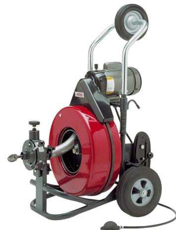
Трос сечением  $\varnothing$  16 mm (также  $\varnothing$  19 mm) и длиной 30 m (увеличивается до 60 m) из прочной стальной проволоки намотанной на 49-жильный сердечник из термически закаленного металла.
