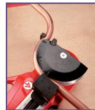
Трубогиб для изготовления промежуточных заготовок на производстве или на стройплощадке. Трубы до Ø35 мм - медь, до 280 - нержавеющая сталь и Ø40 мм - многослойные пластиковые трубы.
