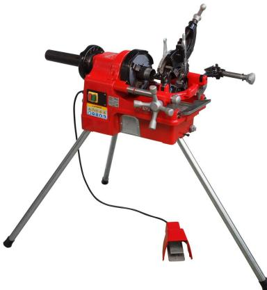
Станок предназначен для нарезания резьбы «для газа» с герметичностью в витках резьбы согласно NFE 03.004 в соответствии с ISO/7.
