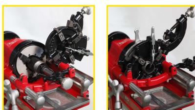
Высокопрочная гребенка: возможны варианты из быстрорежущей инструментальной стали(HSS) и стандартная.
