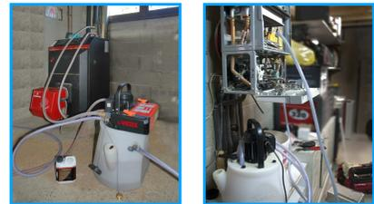
Für die Schlammpumpe zur Verfügung stehendes Zubehör: 20 m langer, transparenter Verlängerungsschlauch (Art.-Nr. 295022) zum Anschließen an den Wasserzulaß, die Abwasserleitung ...
