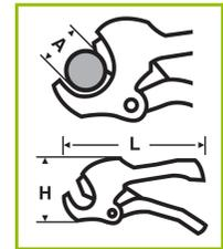
El revestimiento Teflón PTFE (politetrafluoetileno) posee un coeficiente de fricción extremadamente reducido lo que facilita el deslizamiento de la hoja. El esfuerzo de corte se reduce de 20%.
