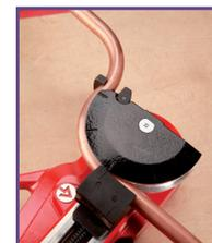
\* 251849 : Ø28mm para tubo acero inox. Ø 28 x 1,2 mm - Radio de curvado 112mm.
