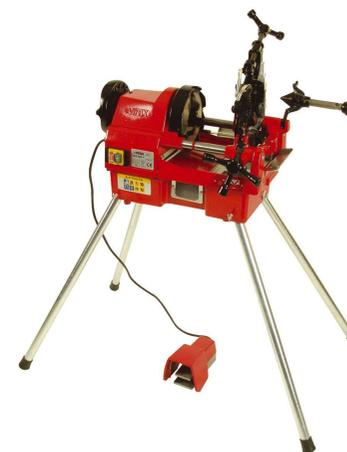
Máquina destinada a la realización de roscados «gas» con estanqueidad en la rosca siguiente NFE 03.004 conforme con ISO/7. Los tubos deben estar conformes con las normas EN 10255 S y EN 10255 W (antigua norma NFA 49115 y NFA 49145 serie media y fuerte); no se aconsejan los tubos serie ligera.
