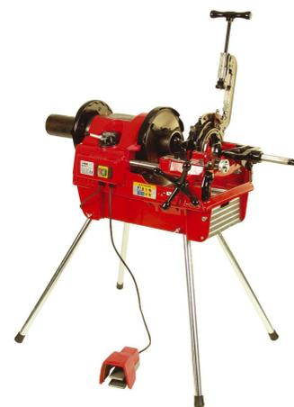
Machine destinée à la réalisation des filetages « gaz » avec étanchéité dans le filet suivant NFE 03.004 conforme à ISO/7.
