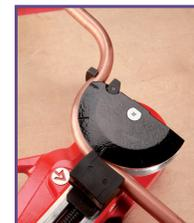
\* 251849 : forme Ø28mm pour tube inox Ø 28 x 1,2 mm - Rayon cintrage 112mm.
