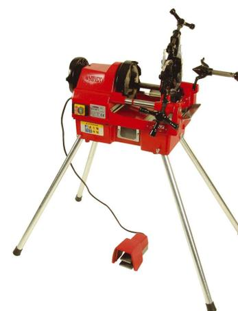
Machine destinée à la réalisation des filetages « gaz » avec étanchéité dans le filet suivant NFE 03.004 conforme à ISO/7.
