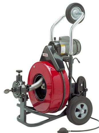
Трос сечением  $\varnothing$  16 мм (также  $\varnothing$  19 мм) и длиной 30 м (увеличивается до 60 м) из прочной стальной проволоки намотанной на 49-жильный сердечник из термически закаленного металла.
