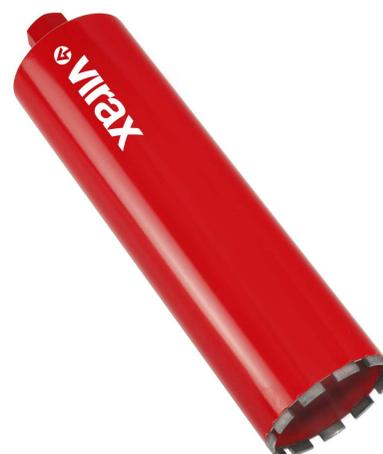
Composición del segmento especialmente optimizado para perforar tanto los materiales abrasivos en seco como los materiales no abrasivos con agua. Para un arranque rápido durante la 1ra utilización: segmentos en punta (Ø 25 – 250 mm) o con esfera de cebado (Ø 300 – 350 mm).
