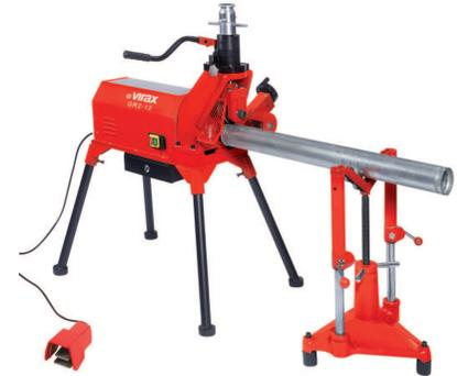
**Ranuradora electro-hidráulica**, para la realización por moleteado en frío de ranuras en tubos estándares en acero y en paredes finas Ø 2" – 12". Para la instalación de sistemas de conducción, riego, grandes instalaciones de calefacción e industriales.
