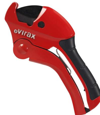
Le revêtement Téflon PTFE (polytétrafluoroéthylène) possède un coefficient de frottement extrêmement faible qui facilite le glissement de la lame. L'effort de coupe est réduit de 20%\*. (\* - 20% en moyenne sur différents types de tubes comparé à une lame avec revêtement classique).
