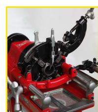
Bomba de óleo de engrenagens com pré-alimentação. Filtro sobrelevado para evitar poluir o óleo em circulação com limalhas. Caudal de óleo regulável.
