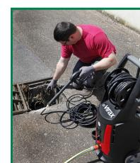
**Função de desentupimento:** limpa e desentope todas as canalizações Ø 40-100 mm obstruídas por entupimentos gordurosos ou friáveis, tais como gordura, lama, sabão, areia e argila.
