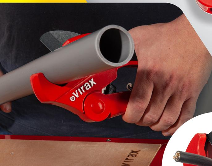
Exemple d'application sur du tube PVC.
