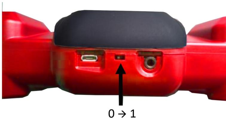
Prima della prima messa in servizio, attivare la batteria nel modo seguente: spingere il contattore verso destra **con precauzione** utilizzando un oggetto appuntito
