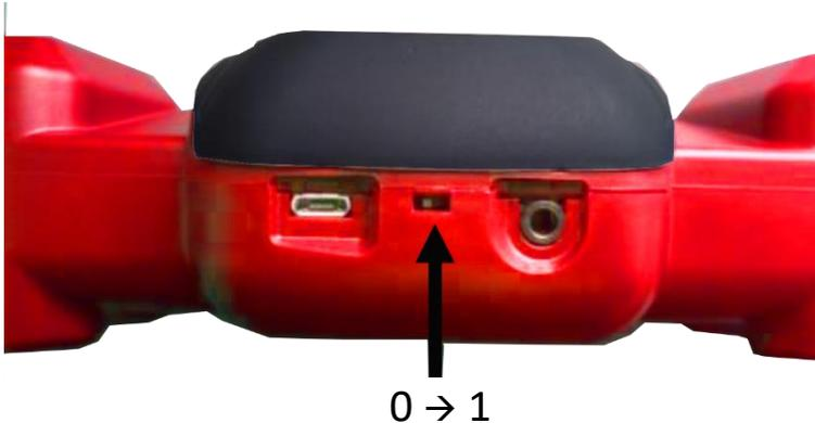
Antes da primeira colocação em serviço, ative a bateria da seguinte forma: empurre **cuidadosamente** o interruptor para a direita com a ajuda de um objeto pontiagudo. Para desativar a bateria (por exemplo, antes do transporte), empurre o interruptor para a esquerda.
