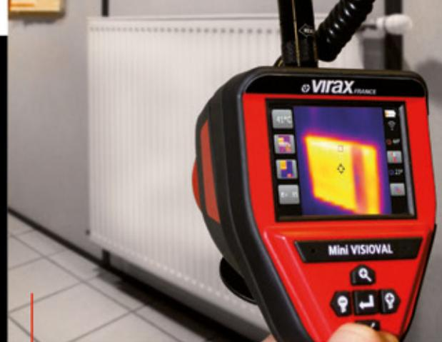
**Diagnóstico térmico y rápido de los fallos de funcionamiento de una red.**
