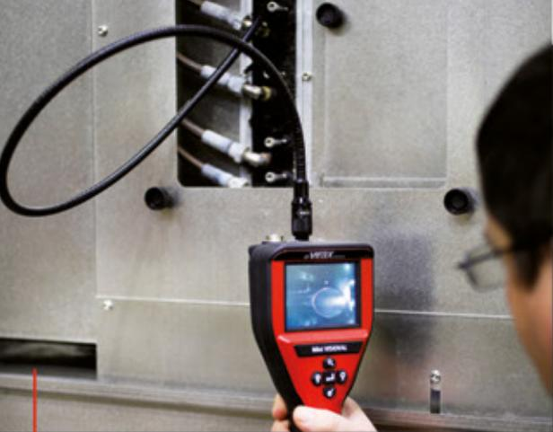
**Inspeccionar lugares estrechos** o de difícil acceso.
