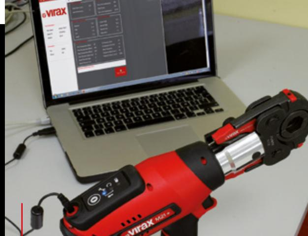
**Comunicante**, informa sul suo stato (batteria, temperatura,...) e permette di anticipare la manutenzione.
