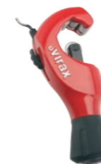
ZR 35 Ø 3 - 35 mm Épaisseur maxi : 3,2 mm. Ébavureur rotatif rétractable à lame interchangeable.
