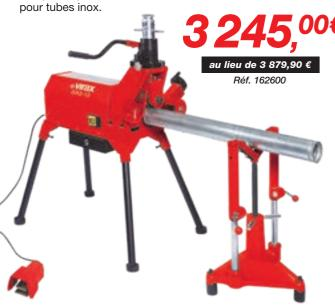
Livré avec rouleaux 2" - 12", support 4 pieds, support de tube 12", pédale de sécurité et mètre ruban pour la mesure du diamètre.
